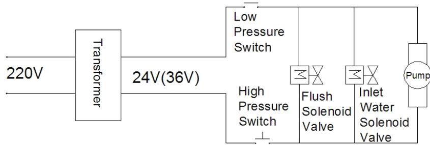
**Diagram 2-2** (自动冲洗直饮水机)
